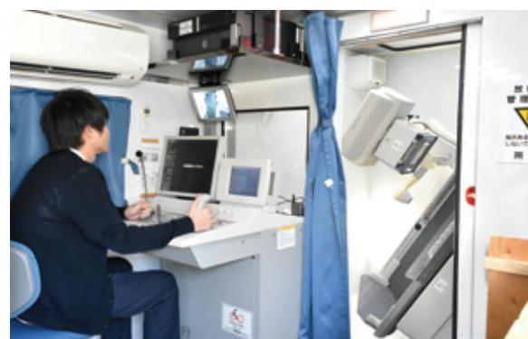
検診車内で胃部X線検査の様子です。デジタル撮影なので、すぐに画像が表示されます。胸部X線検査装置も搭載しており、1台で胃部と胸部の両方を検診できます。
